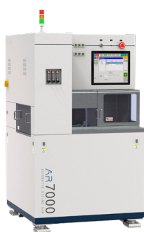
Установка дисковой резки пластин диаметром до 12"
