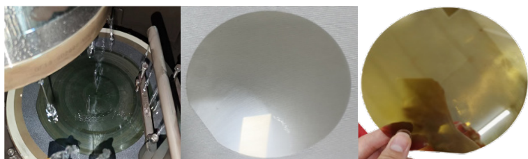
Обработка пластины из SiC: грубая шлифовка (#2000) и прецизионная шлифовка (#8000)
